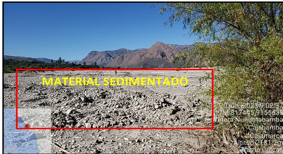
FIGURA N°02: TRAMO CRÍTICO COLMATADO APROXIMADAMENTE UNA PROFUNDIDAD PROMEDIO DE 0.70 M, LO QUE REDUCE LA CAJA HIDRAULICA DEL RÍO Y PRODUCE EL DESBORMAMIENTO.
